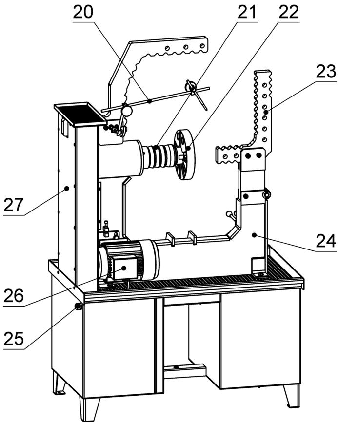
**20** – указатель биения; **21** – вал шпинделя с опорными выступами;
