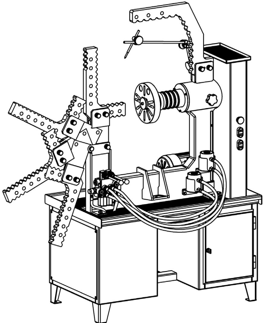
**4. 1. 9.** Шпиндель представляет собой вал, изготовленный из легированной конструкционной стали с повышенной износостойкостью и прочностью, с концентрически выполненными опорными площадками, на окончании которого смонтирована планшайба.
