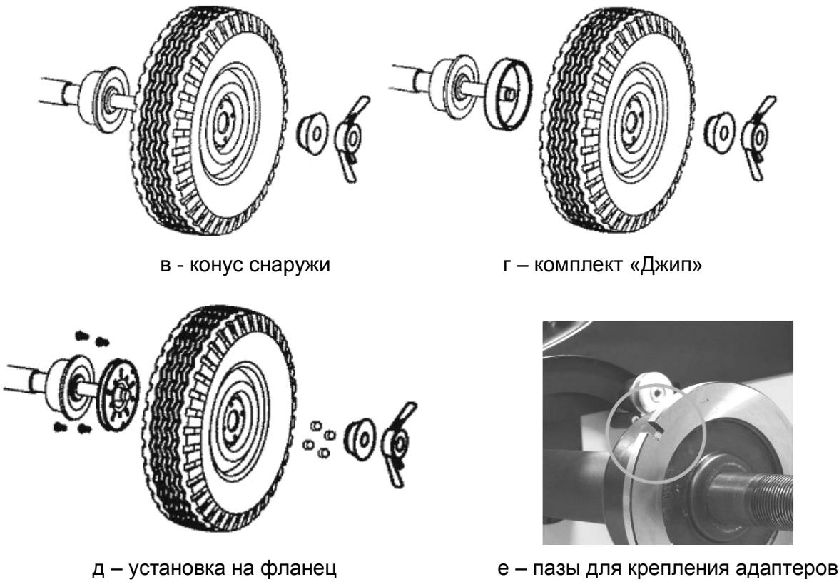
Рисунок 5.1 – Установка колеса
