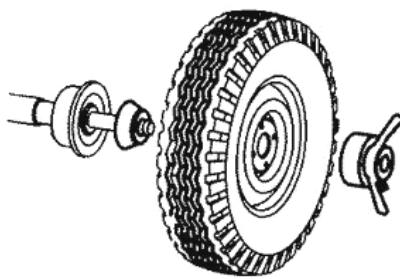
Рисунок 6.2 – Установка колеса
