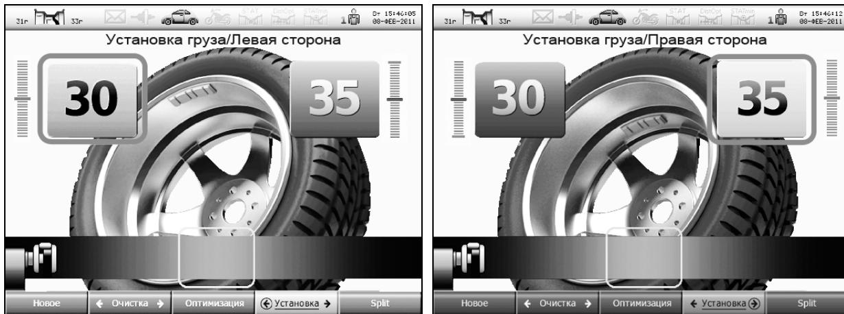
а – установить ленточный груз 30 г слева      б – установить ленточный груз 35 г справа
