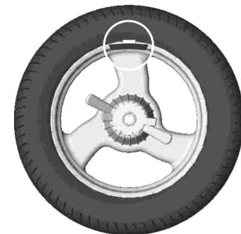
б - груз установлен в положение «12 часов»
