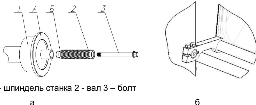
1 - шпиндель станка 2 - вал 3 – болт
