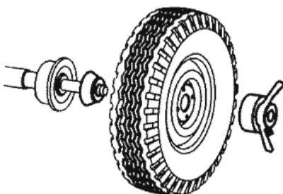
Рисунок 6.9 – Установка колеса
