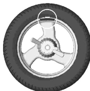
Рисунок 6.6 - Груз установлен в «12 часов»
