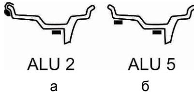
Рисунок 7.1 – Допустимые схемы установки грузов для режима Split
