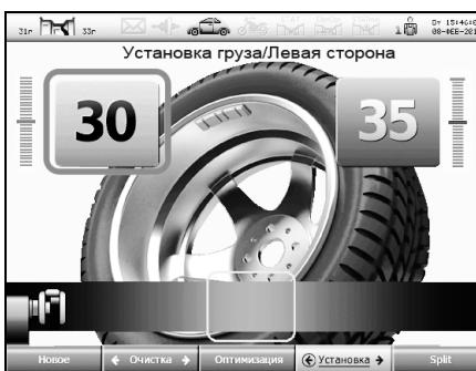
б – установка груза линейкой
