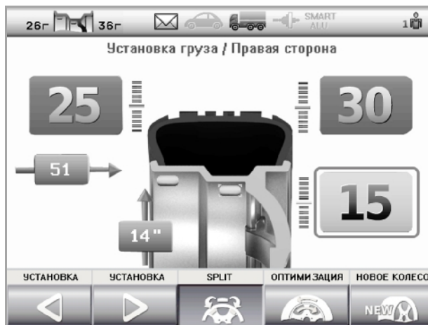
Рисунок 7.5 – Экран установки грузов в режиме Split
