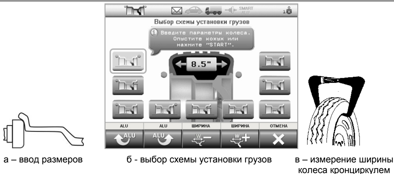
Рисунок 6.2 - Ввод параметров стандартного колеса
