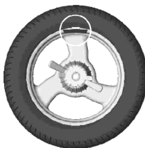
Рисунок 6.3 – Груз установлен в положение «12 часов»
